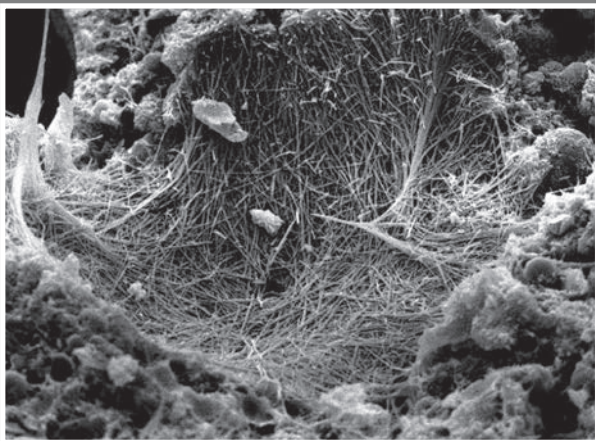
CALCESTRUZZO TRATTATO CON XYPEX
